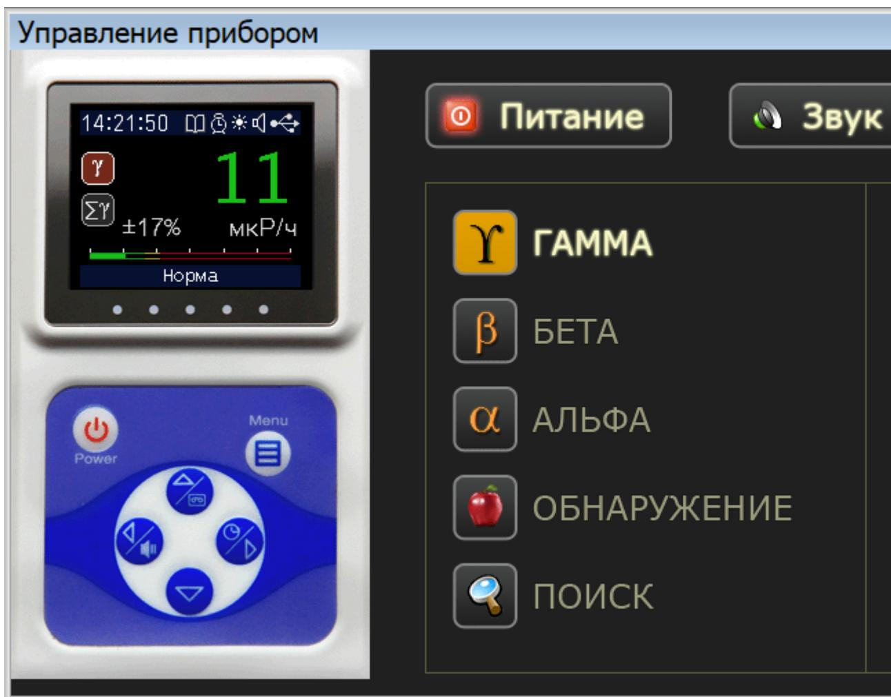
С помощью кнопок окна при включенном питании прибора можно выполнять операции по переключению режимов измерения, перезапускать измерения, включать и выключать звуки и экран прибора и т.п.
