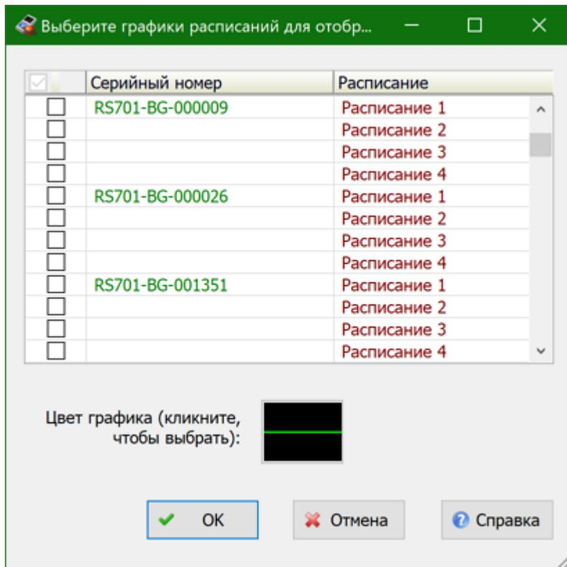
В левой колонке отображаются серийные номера приборов RadiaScan-x01, данные которых присутствуют в базе. В правой колонке - расписания от 1 до 4. Серийные номера и расписания отображаются независимо от того, есть для этих приборов данные измерений по расписанию или нет.
