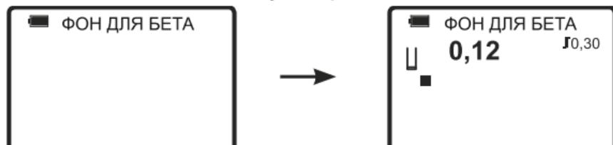
В течение четырех циклов дозиметр производит измерение гамма- фона, по окончании измерения значение выводится на дисплей:
