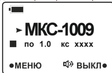
Измерение МЭД фотонного излучения и плотности потока бета-излучения начинается в момент включения дозиметра. В течение времени измерения каждые регистрируемые квант и бета-частица излучения сопровождается индикацией на дисплее пиктограммы «
