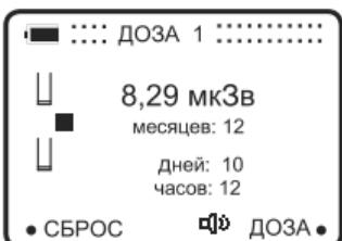
Нажатие кнопки «СБРОС», во время индикации экрана «ДОЗА», обнуляет накопленную дозу. Для обнуления накопленной дозы следует нажать и удерживать кнопку А, далее нажать и удерживать кнопку В, отпустить кнопку А,
