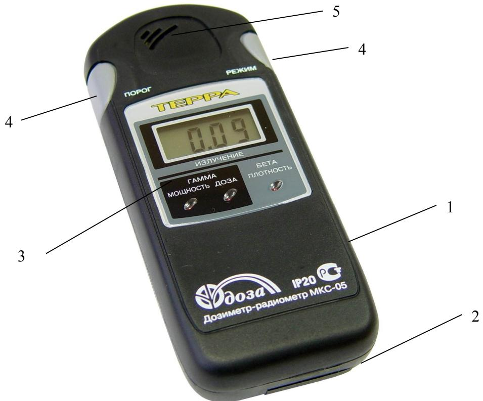
Рисунок 1.1 - Общий вид дозиметра
