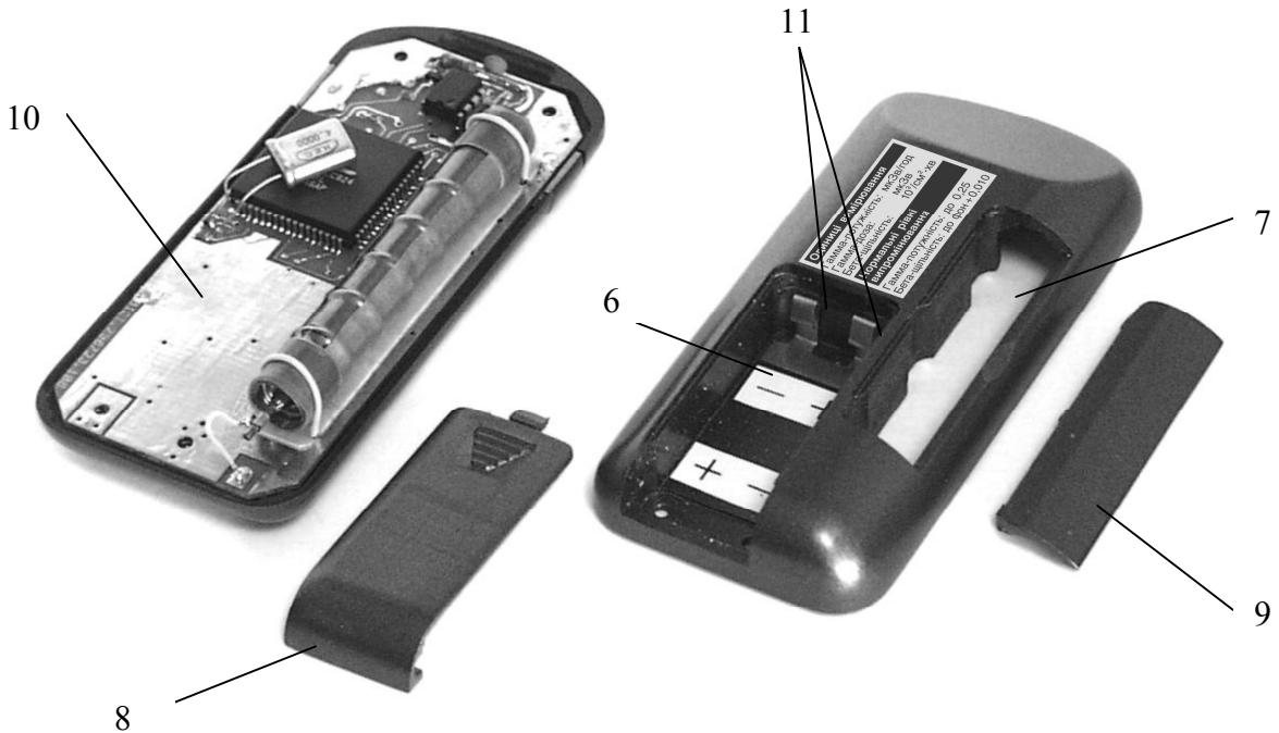
Рисунок 1.2 - Вид сзади со снятой нижней крышкой
