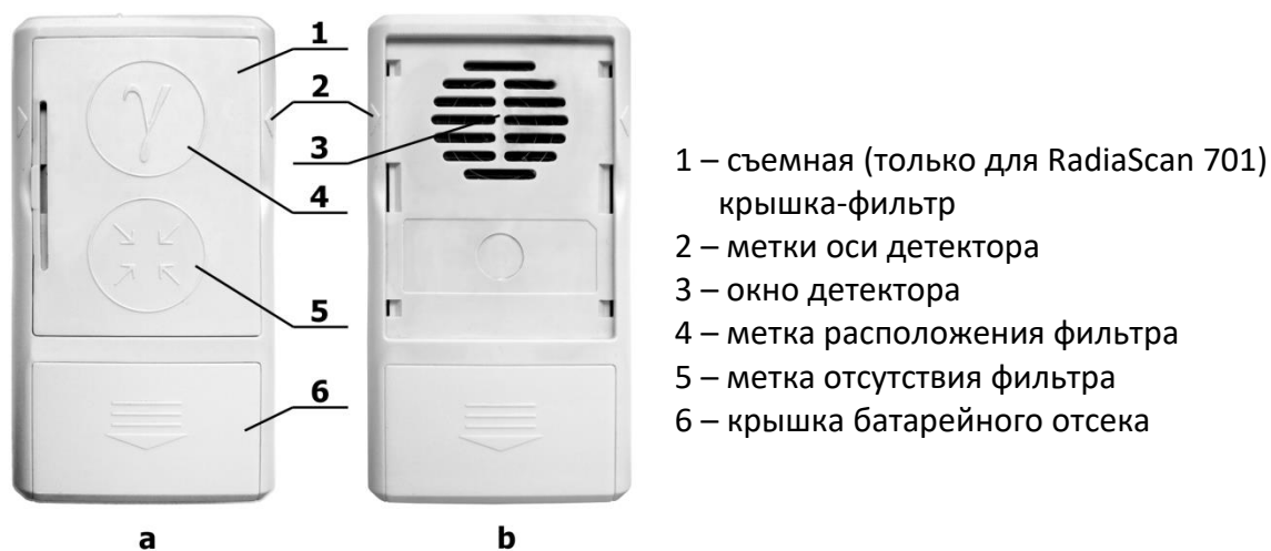
Рис. 4 Внешний вид обратной стороны RadiaScan-701(601)
